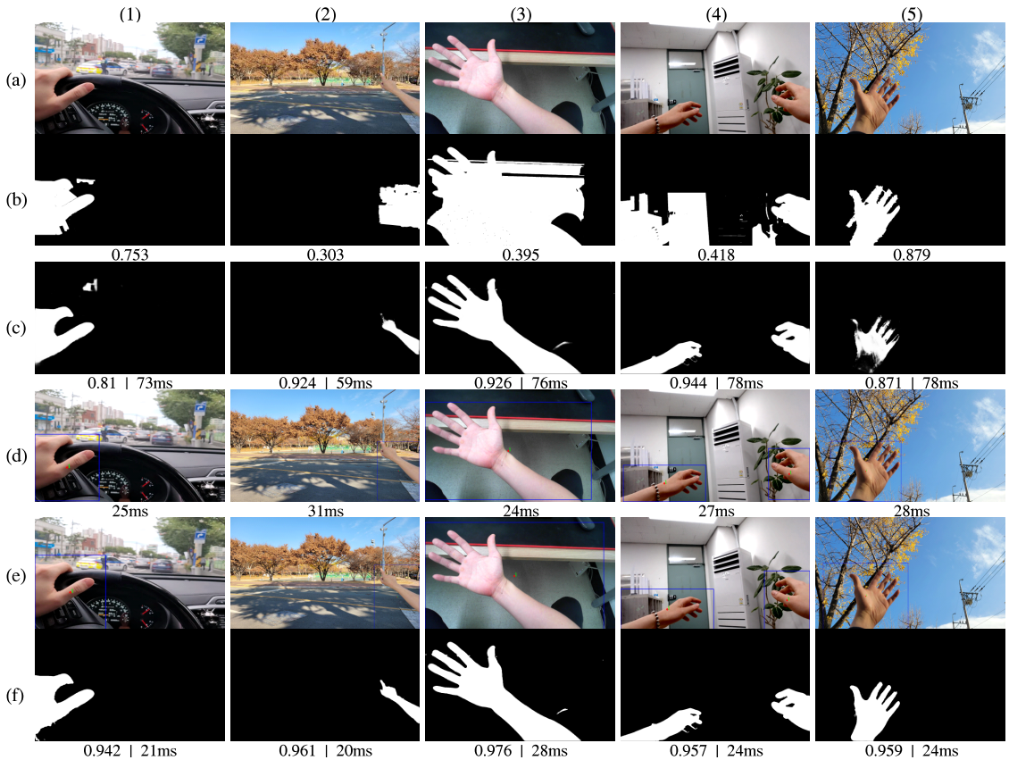
그림 15. 제안하는 알고리즘을 적용한 결과: (a) 원본 이미지, (b) GrabCut 적용 결과와 IoU, (c) U-Net 적용 결과 IoU와 분할 시간, (d) YOLOv4를 적용 결과 시간, (e) ROI Expanding 적용 결과, (f) 제안하는 알고리즘 적용 결과 IoU와 분할 시간 Fig. 15. Result of the proposed method: (a) original image, (b) GrabCut result and IoU, (c) U-Net result IoU and segmentation time, (d) YOLOv4 result, (e) ROI Expanding result, (f) proposed method result IoU and segmentation time
